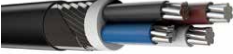
0,6/1 kV NAYFGbY, Çok Damarlı Enerji Kablosu, Alüminyum İletkenli, PVC izoleli, Çelik Tel ve Bant Zırlı, PVC Kılıflı
