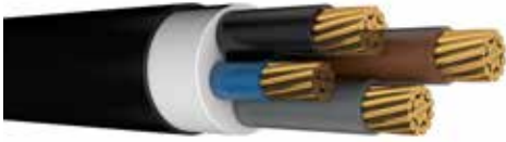
0,6/1 kV N2XH, Tek veya Çok Damar Enerji Kablosu, Bakır İletkenli, XLPE izoleli, HFFR kılıflı
